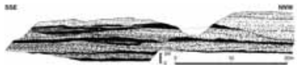
図7 米国アリゾナ州の扇状地をつくって流れる網状河川（上）と、三重県伊賀市島ヶ原の砂利採取場に露出する古琵琶湖層群伊賀累層の砂礫層に見られる典型的な網状河川堆積物の断面図（下）
