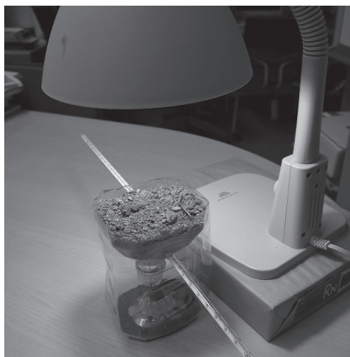
図9 ツルグレン装置の土の温度変化を測定している様子
