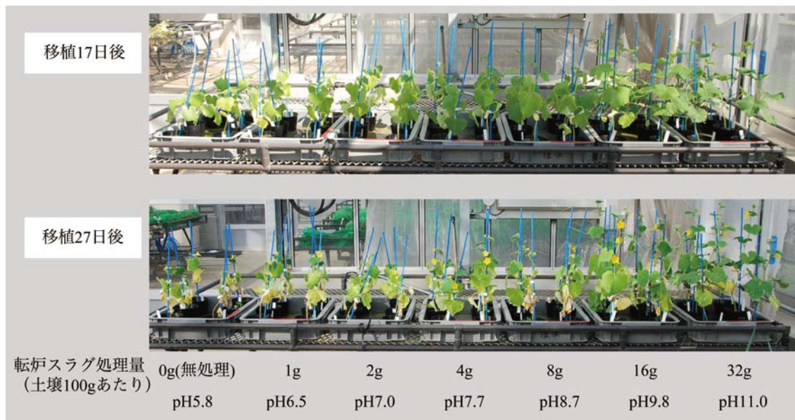
第5.1.1図 汚染土壌への転炉スラグ処理量とキュウリホモプシス根腐病発病抑制効果(移植17日後、27日後)
