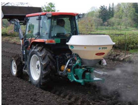
第 6.5 図 ブロードキャスターによる転炉スラグ処理
