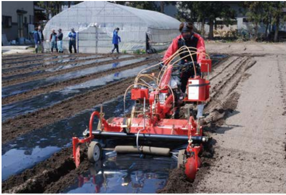
第 4.6.1 図 クロールピクリン マルチ畦内処理
