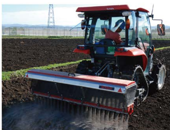
第 6.7 図 ライムソーヤーによる転炉スラグ処理
