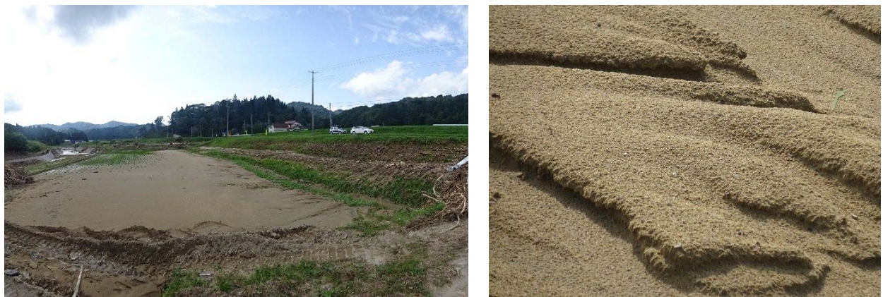
図 43. 左岸上流側の堆砂状況（比較的均質な砂が堆積している）
