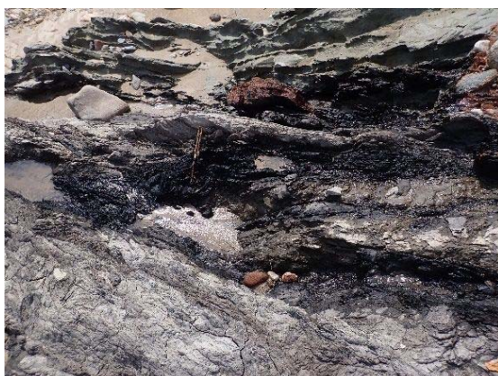
図 40. 竹原橋下流左岸に露岩する基盤岩（高峰層）の分布状況 ※砂岩・泥岩（亜炭層を複数挟む）の互層状となっており、明瞭な背斜構造を有する
