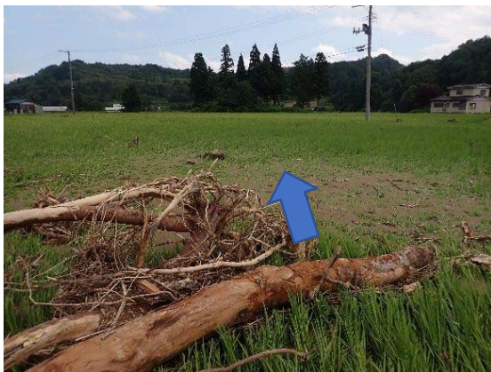
図 31. 北向橋右岸の土砂堆積状況 ※土砂は北向橋周辺から広範囲に分布している（左岸の土石流とは異なる方向）
