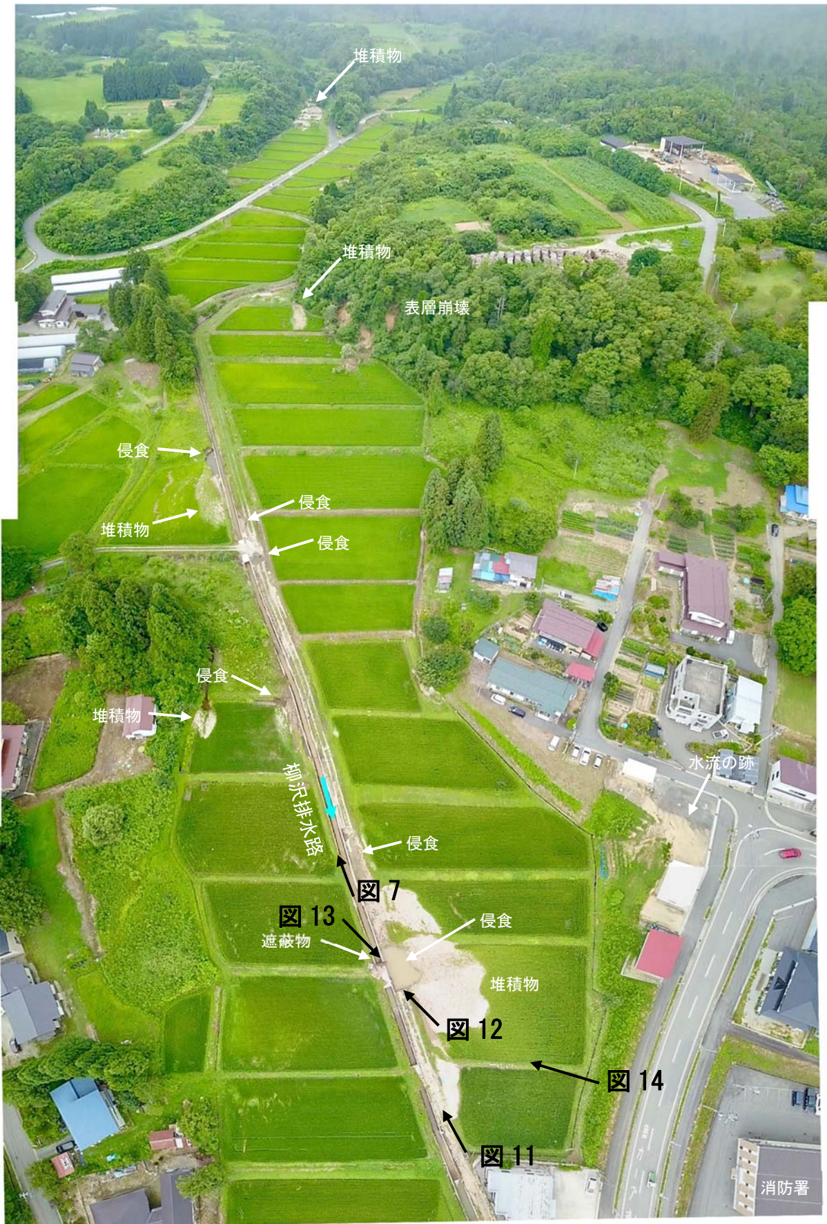
図 8. 柳沢排水路の変状. 消防署付近から西方を望む (8月7日 11:00 頃空撮)
