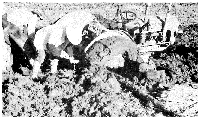
耕盤の軟い水田で車輪 の滑りが始ると、段々沈 下して、自力では上れな くなる。
