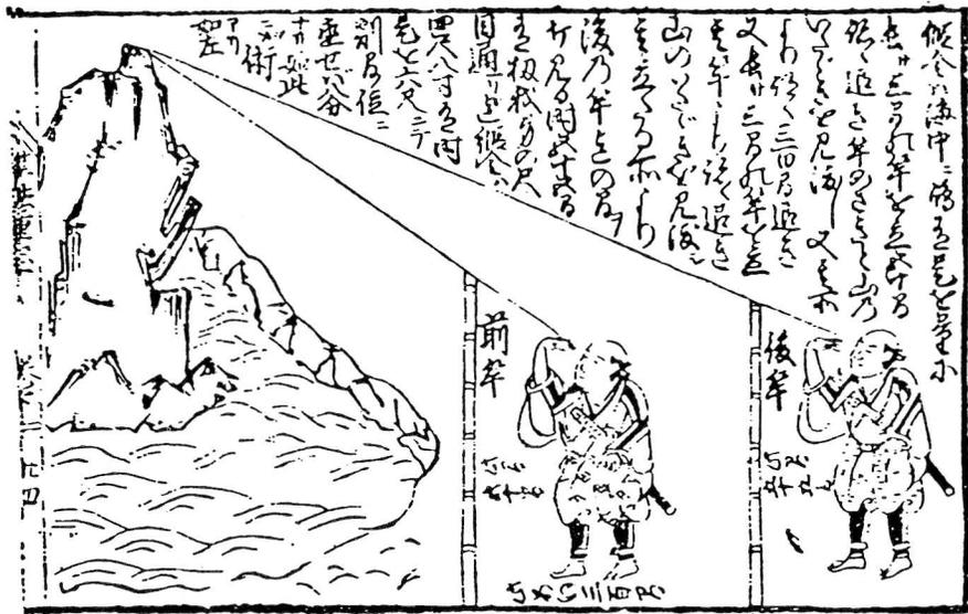
図-6 竿を進退させて山の高さを測る
