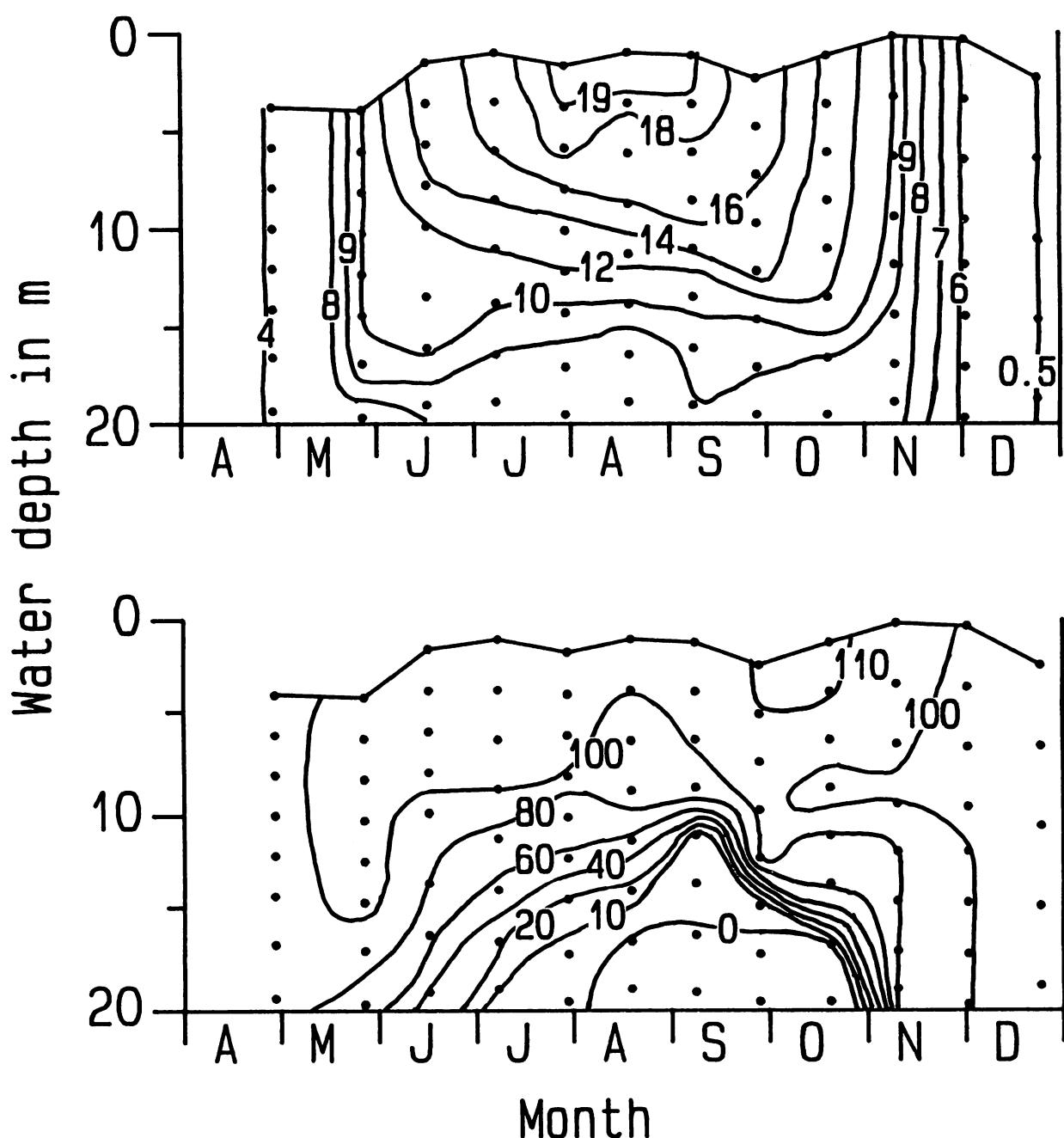
図2. 小野川湖の水温と溶存酸素の時空間分布
