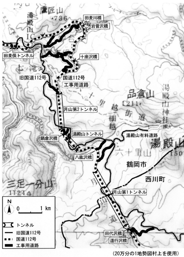
図6 国道112号の工事用道路の位置
