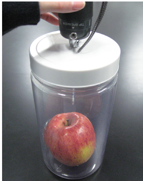
図4 検知管式エチレン測定器を用いてエチレン濃度を測定している様子
