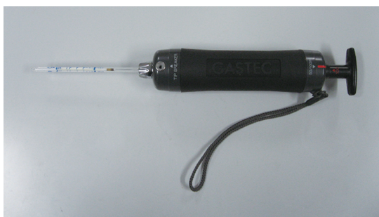
図1 気体検知管を取り付けた気体採取器セット
