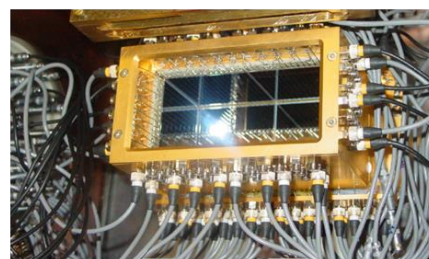
図 1.3.5 FLNR で使用されている焦点面検出器の概念図（左）。2 台の飛行時間検出器と Si-box からなる。右上の写真（過去に使用されていたもの）は 11 台の検出器、右下の写真（現在使用されているもの）は 8 台の検出器が箱型に配置されている[29]。
