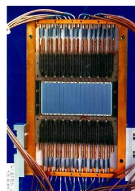
図 1.3.6 GSI で使用されている焦点面検出器の概念図（左）。3 台の飛行時間検出器と Si-box からなる。7 台の検出器が箱型に配置されており、右の写真は PSD である[30]。
